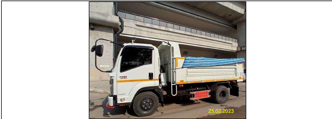
รูปที่ 2-3 การปกคลุมและผูกมัดวัสดุอุปกรณ์รถบรรทุกขณะขนย้าย
